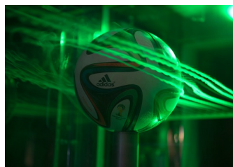
En haut : visualisation expérimentale de l'écoulement d'air autour d'un ballon de football [NASA Ames Research Center].
