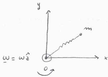
$Oxy$  en ROTATION UNIFORME:  $\underline{\omega} = \omega \hat{z}$ ;  $\dot{\omega} = 0$
